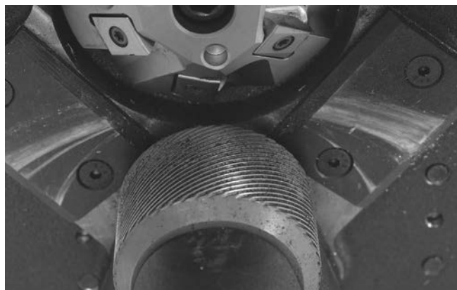
16. ábra – A hajtógörgő recézésének megtisztítása
