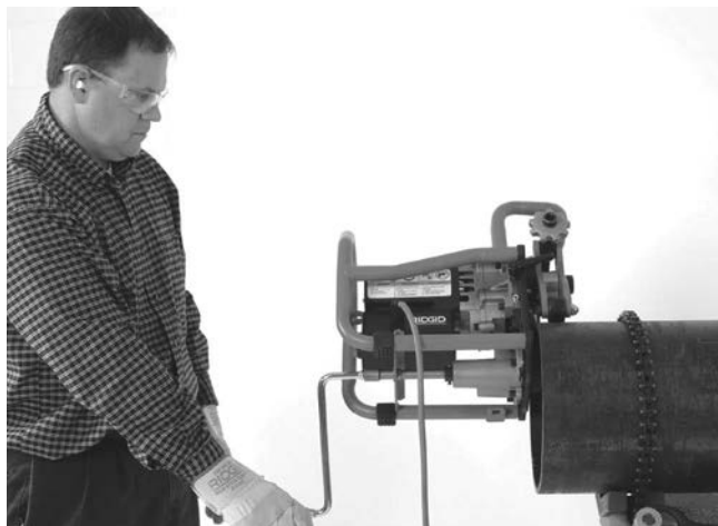
Rys. 15A – Operacja ukosowania
