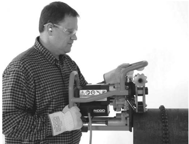
Figura 8A – Collocamento della Smussatrice sul Tubo
