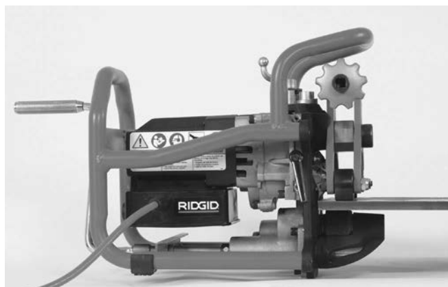
Slika 9B – Nameščanje posnemaleca robov na ploščo
