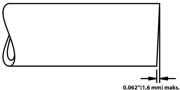
Slika 6 – Zahtjevi za rezanje cijevi pod pravim kutom
