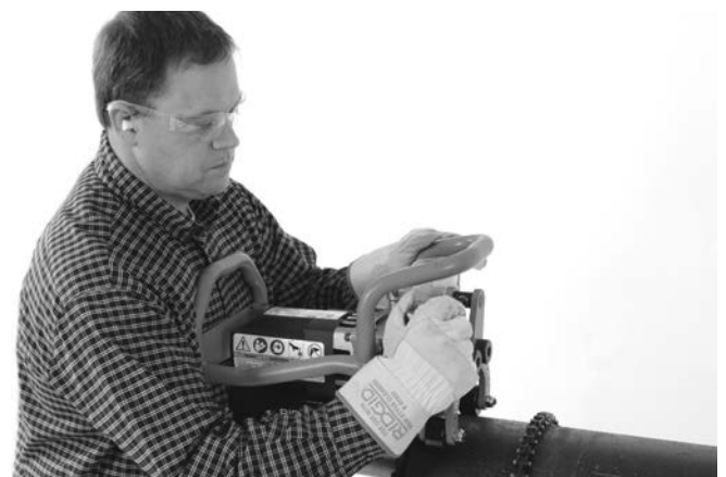
Figura 10A – Con la mano, apriete el tornillo de sujeción
