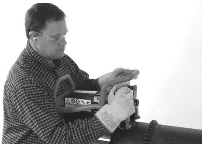
Figura 10A – Aperto Manual do Parafuso de Aperto
