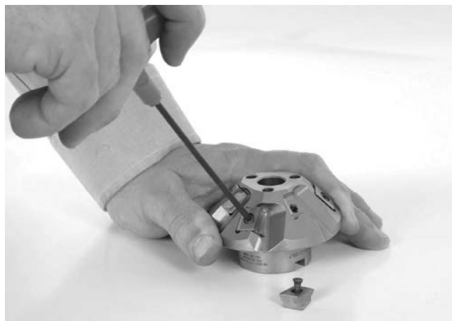
Figura 18 – Substituir Entalhes de Corte
