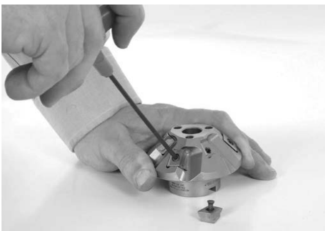
Slika 18 – Zamena reznih umetaka
