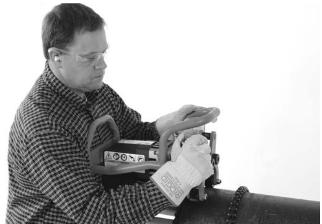
Figure 10A – Serrer la vis de blocage manuellement
