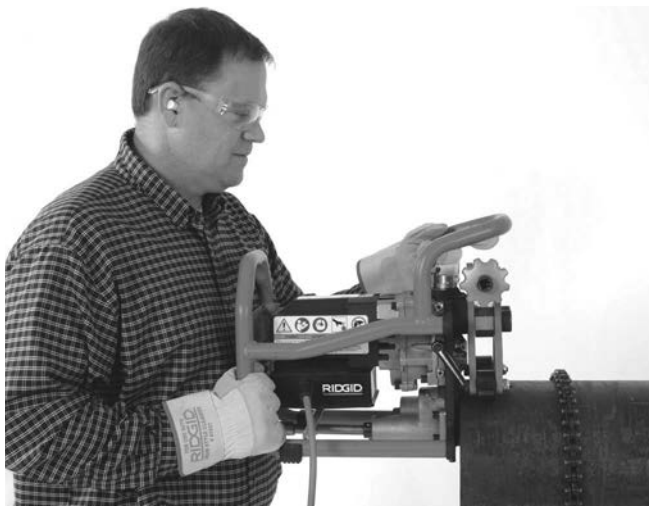
Obrázek 8A – Umístění úkosovačky na trubku
