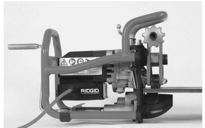
Abbildung 9B – Anbringen des Anfasgeräts an einer Platte
