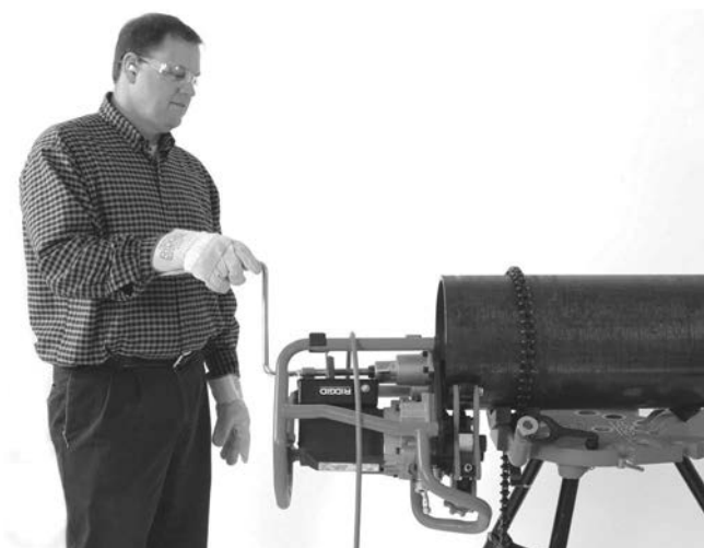
Figura 15B – Operazione di smussatura
