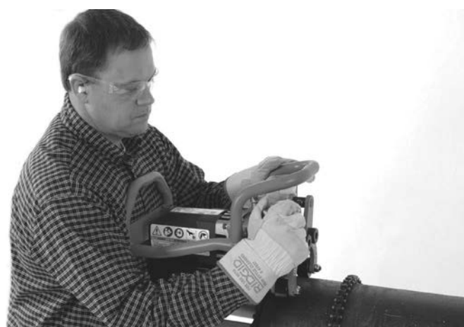
Figur 10A – Tilspænding af spændeskruen med håndkraft
