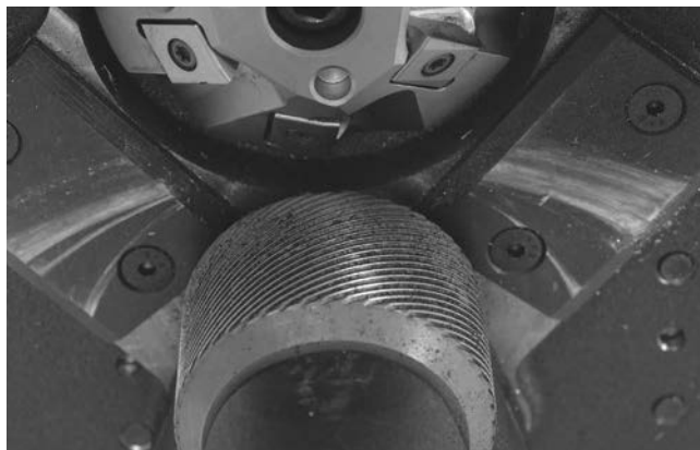
Εικόνα 16 – Καθαρίστε τις ραβδώσεις του κυλίνδρου μετάδοσης κίνησης
