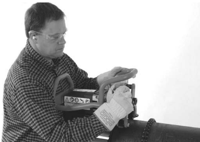
Εικόνα 10A – Σφίξτε τη βίδα σύσφιξης με το χέρι
