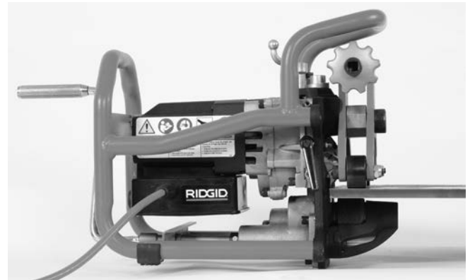
Figure 9B – Montage de la machine à biseauter sur tôle
