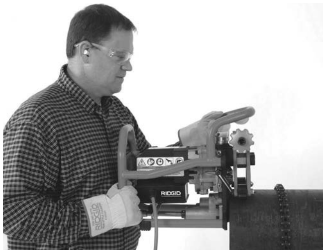
Figur 8A – Placering af affasningsværktøjet på et rør
