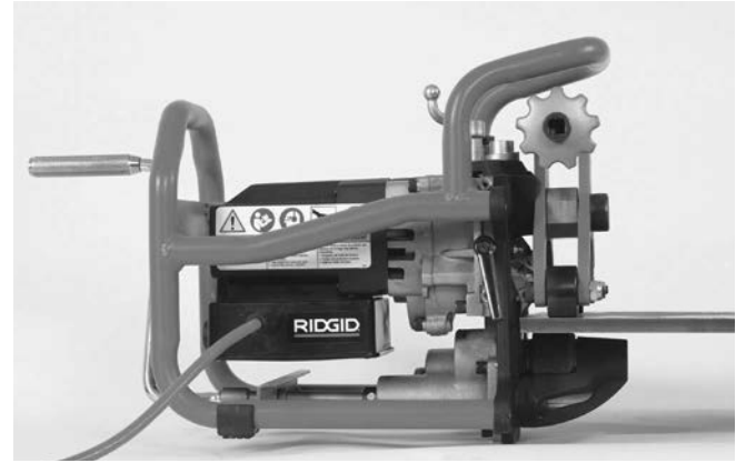
Şekil 9B – Pahlama Makinesinin Plakanın Üzerinde Kurulması
