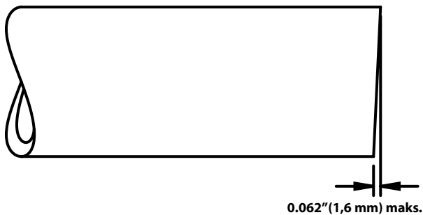
Kuva 6 – Putken suorakulmaisuusvaatimukset
