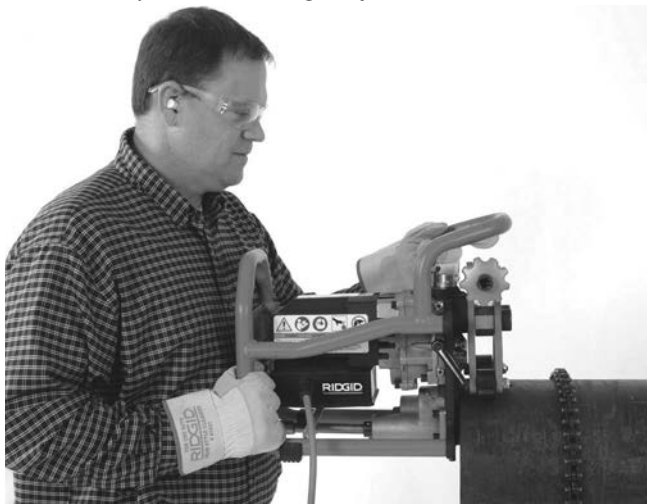
Slika 8A – Postavljanje alata za upuštanje rubova na cijev
