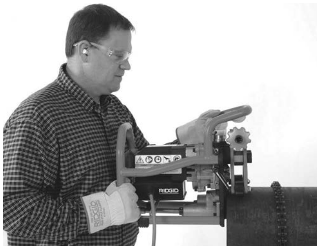
Slika 8A – Nameščanje posnemalec robov na cev
