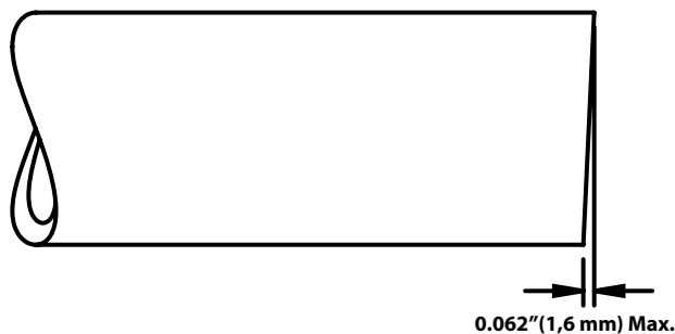
Figur 6 – Krav på rörets rätthet
