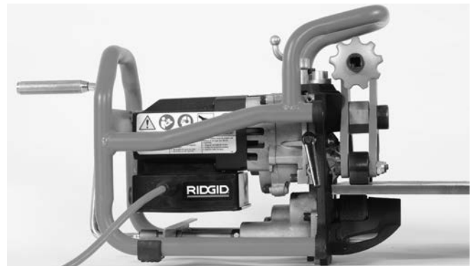
Figura 9B – Colocación de la biseladora sobre una chapa
