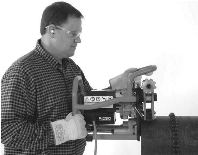
Abbildung 8A – Platzieren des Anfasgeräts am Rohr
