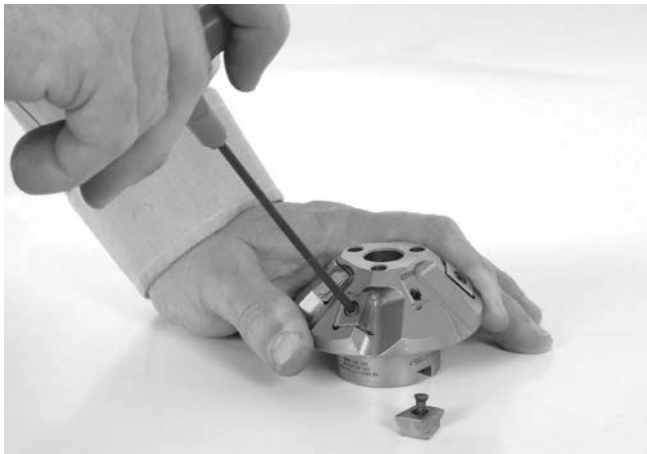
Slika 18 – Zamjena reznih umetaka
