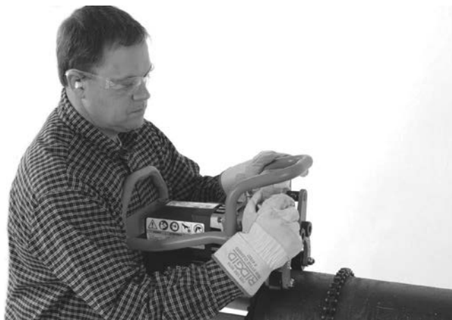
Slika 10A – Rukom zategnite stezni zavrtnaj
