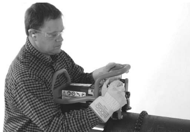
Slika 10A – Rukom zategnite stezni vijak
