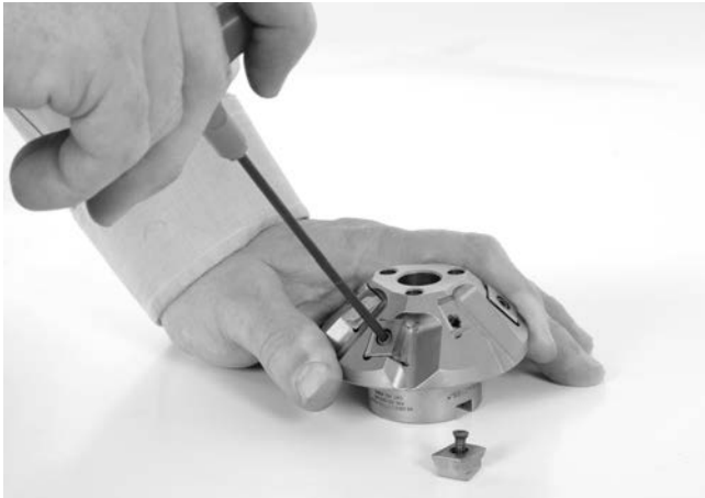
Figura 18 – Cambio de las placas de corte en el cabezal
