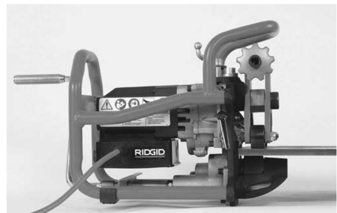
Εικόνα 9B – Εγκατάσταση του εργαλείου φρεζαρίσματος πάνω σε πλάκα
