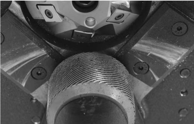
Figure 16 – Nettoyage du moletage du galet d'entraînement
