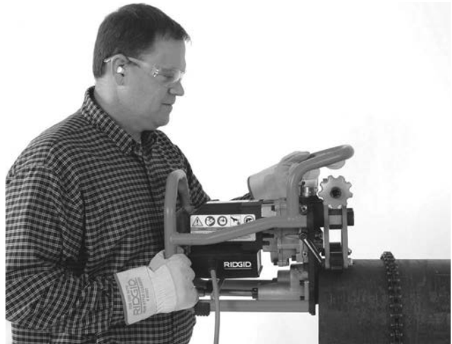
8A ábra – A leélező gép elhelyezése a csövön
