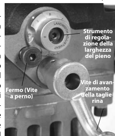
Figura 12 – Impostazione dello Strumento di regolazione della larghezza del pieno
