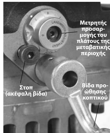
Εικόνα 12 – Ρύθμιση του μετρητή προσαρμογής του πλάτους μεταβατικής περιοχής
