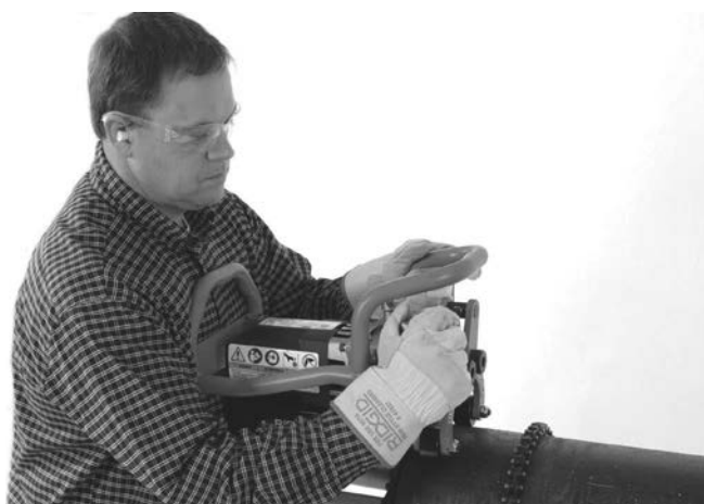
Figura 10A – Stringere a mano il Morsetto a vite
