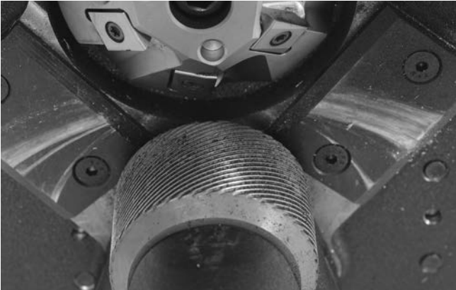
Figura 16 – Superficie moleteada del rodillo de mando, limpia
