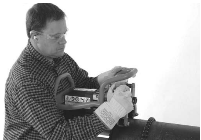
Figuur 10A – Klemmschroef met de hand vastdraaien
