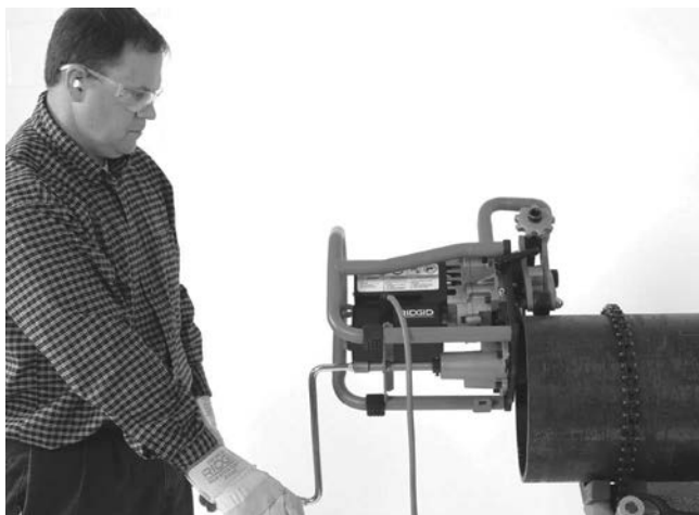
Figura 15A – Operazione di smussatura
