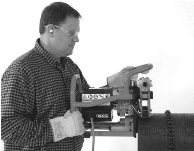
Figur 8A – Placera avfasaren på röret
