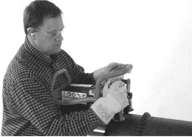
Şekil 10A – Sıkıştırma Vidasını Elle Sıkın
