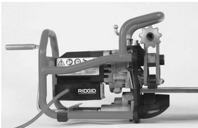
Рис. 9В – Установка станка для снятия фаски на лист
