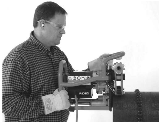
Figura 8A – Colocar o Biselador no Tubo
