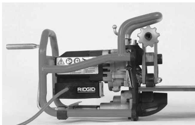
Rys. 9B – Zakładanie ukosowarki na płycie
