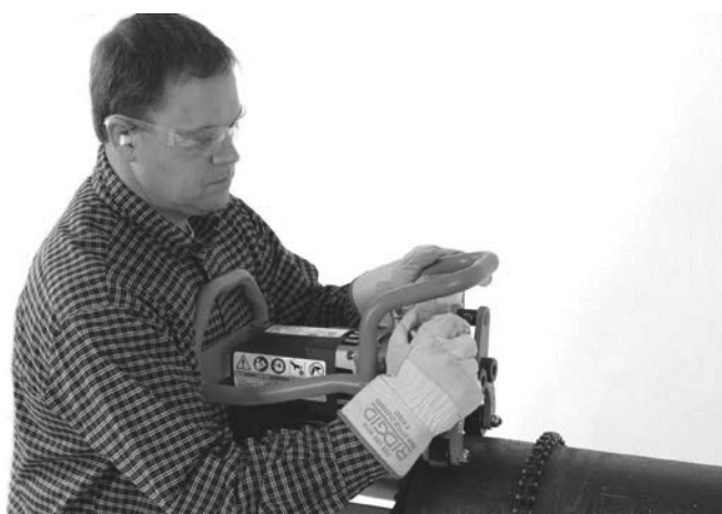
Slika 10A – Ročno pritegnite vpenjalni vijak
