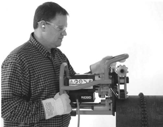
Kuva 8A – Viisteleikkurin asettaminen putkeen
