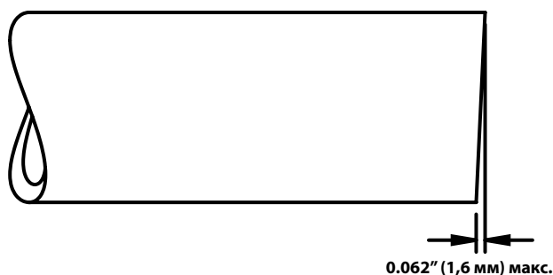
Рис. 6 – Требования прямоты трубы
