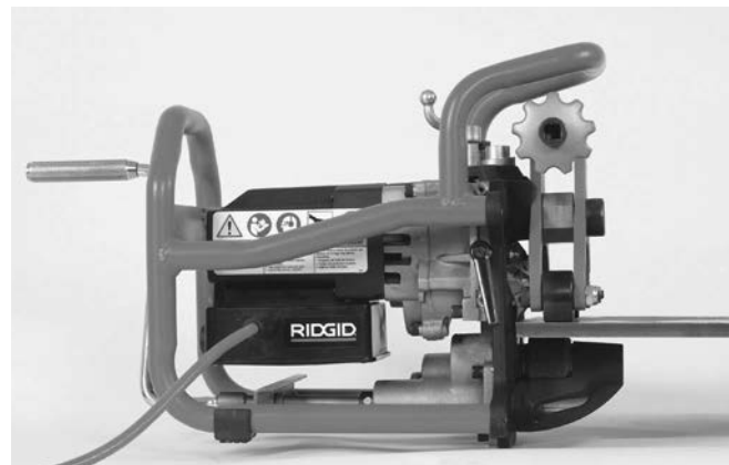
Slika 9B – Montaža alata za upuštanje rubova na ploču
