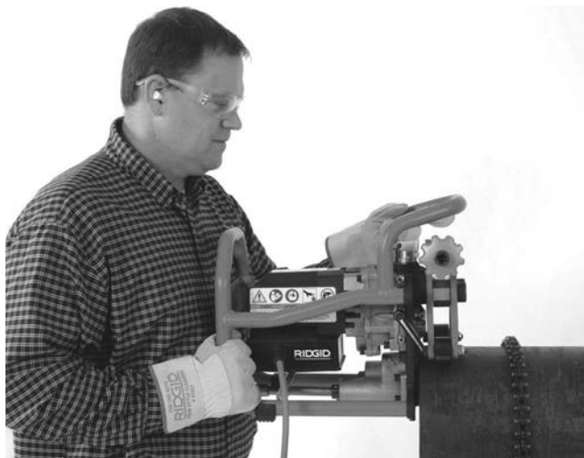
Obrázok 8A – Umiestnenie úkosovačky na rúru
