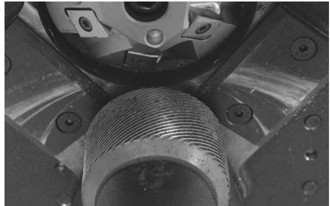
Abbildung 16 – Reinigen der Rändelung der Antriebsrolle
