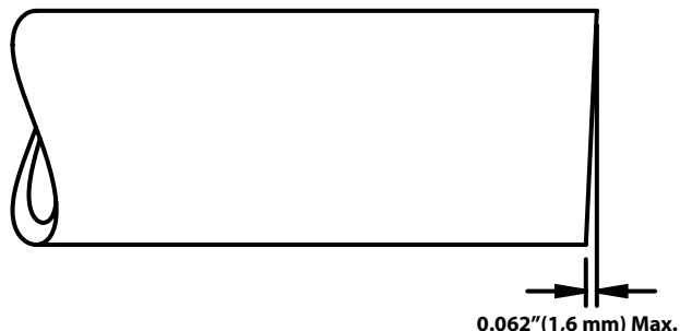
6. ábra – A cső merőlegességére vonatkozó követelmények
