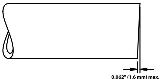
Figuur 6 – Rechtheidstolerantie van de pijp
