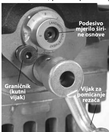
Slika 12 – Podešavanje podesivog mjerila širine osnove
