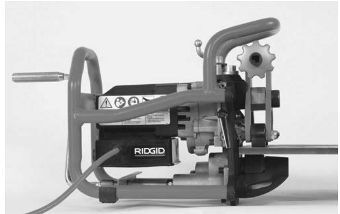
Figur 9B – Montera avfasaren på plåten
