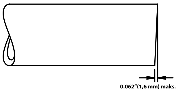
Figur 6 – Krav til rørets rettinklethet
