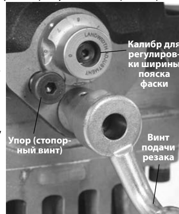
Рис. 12 – Установка калибра для регулировки ширины пояска фаски
