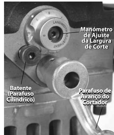
Figura 12 – Definição do Manómetro de Ajuste da Largura de Corte
