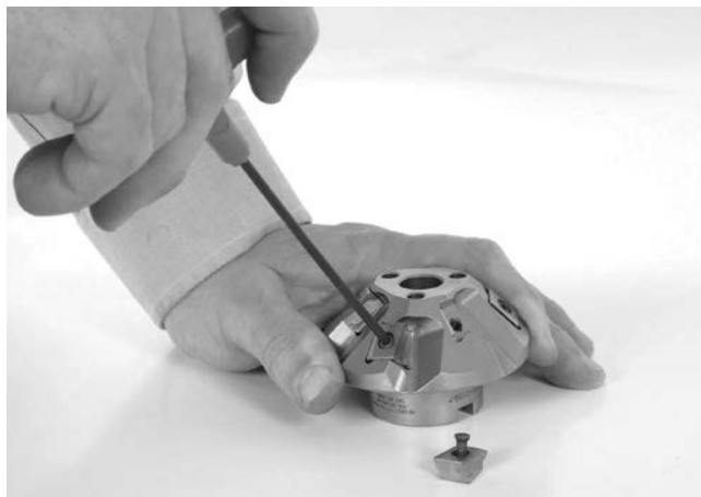
Rys. 18 – Wymiana płytek wieloostrowych
