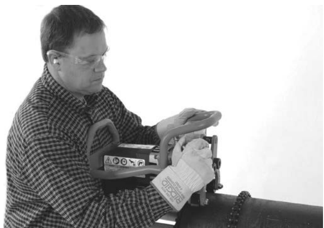
Figur 10A – Stram klemmeskruen til for hånd
