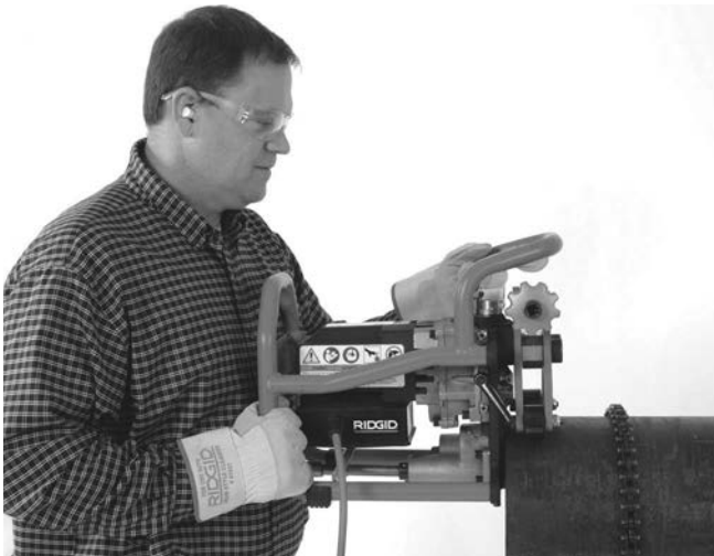
Figur 8A – Sette fasemaskinen på røret
