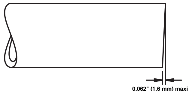
Figure 6 – Faux équerre maximal du tuyau
