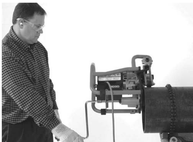
Obrázek 15A – Provedení ukosení
