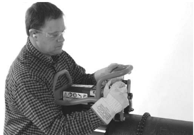
Figur 10A – Dra åt låsskraven med handkraft
