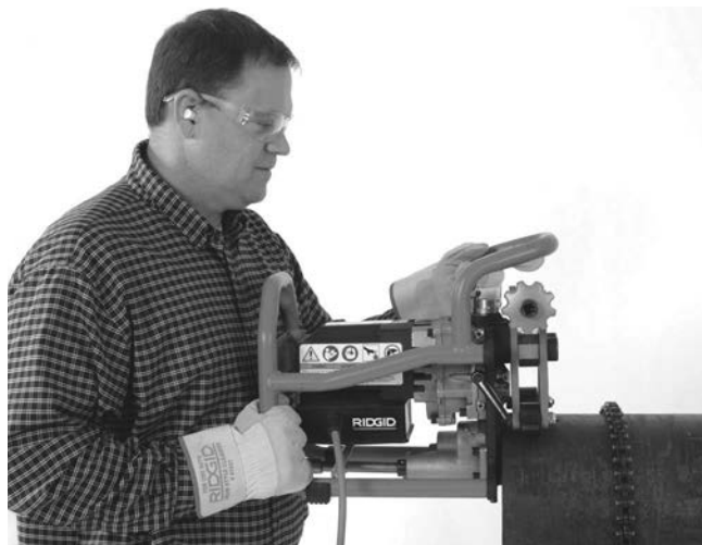
Εικόνα 8A – Τοποθέτηση του εργαλείου φρεζαρίσματος πάνω σε σωλήνα
