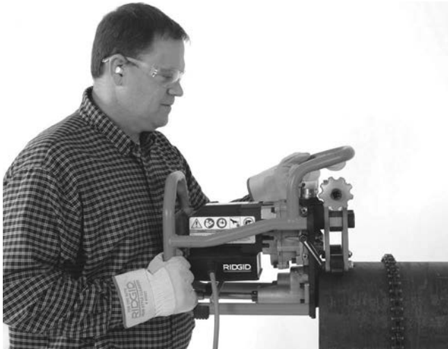
Figuur 8A – Afschuinapparaat op de pijp plaatsen
