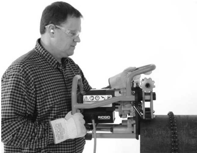
Figura 8A – Colocación de la biseladora sobre el tubo
