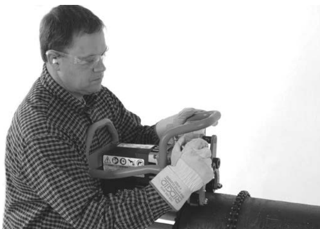
Figura 10A – Strângerea manuală a șurubului clemei de prindere
