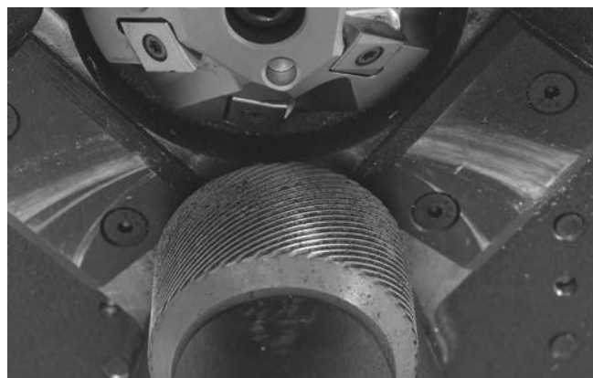
Rys. 16 – Czyszczenie radełek rolki posuwu
