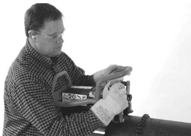
Rys. 10A – Ręczne dokręcanie śruby zaciskowej
