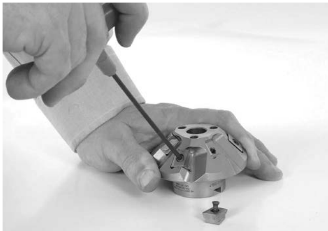
Slika 18 – Zamenjava rezalnih vstavkov
