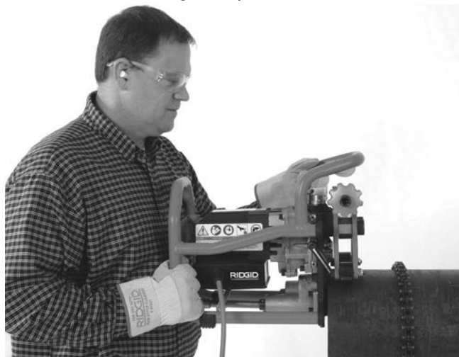
Figura 8A – Așezarea mașinii de șanfrenare pe țevă
