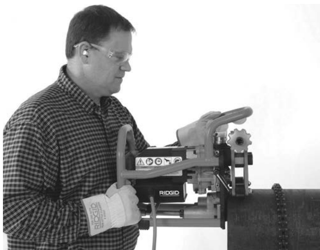
Slika 8A – Postavljanje alata za obaranje ivica na cev
