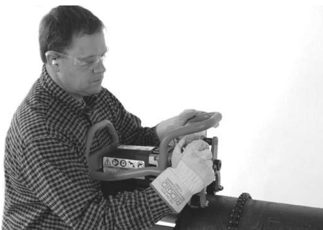
10A ábra – A befogócsavar megszorítása kézzel
