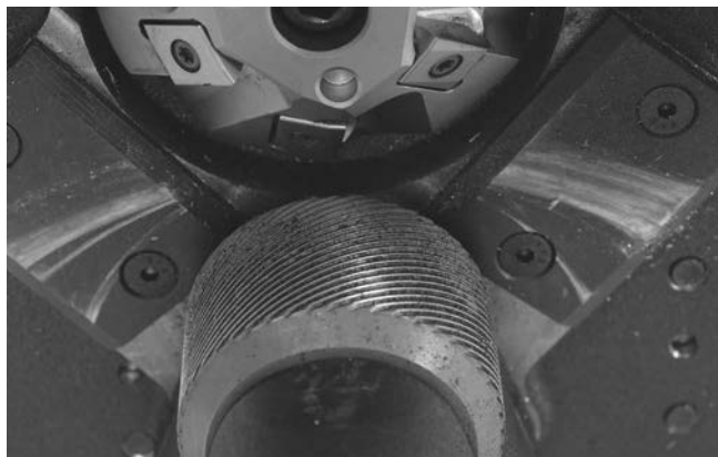
Рис. 16 – Чистые насечки ведущего ролика
