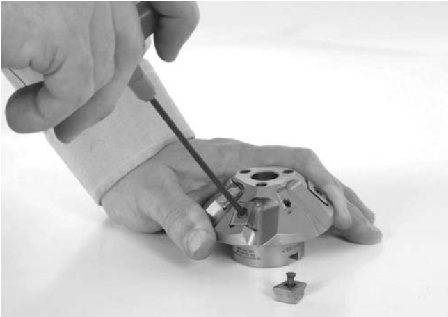
Şekil 18 – Kesici Bagaların Değiştirilmesi
