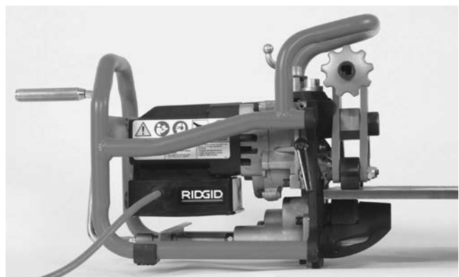
Figur 9B – Påmontering af affasningsværktøjet på en plade
