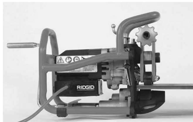
Obrázek 9B – Umístění úkosovačky na plech
