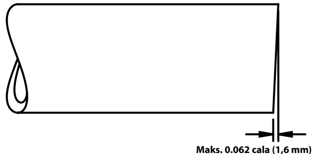
Rys. 6 – Wymóg kąta prostego krawędzi rury
