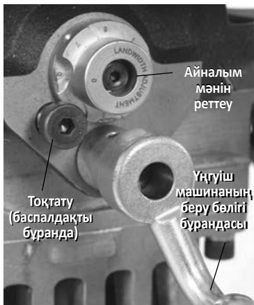
12-сурет – Айналым мәнін реттеудің өлшеуіш параметрі
