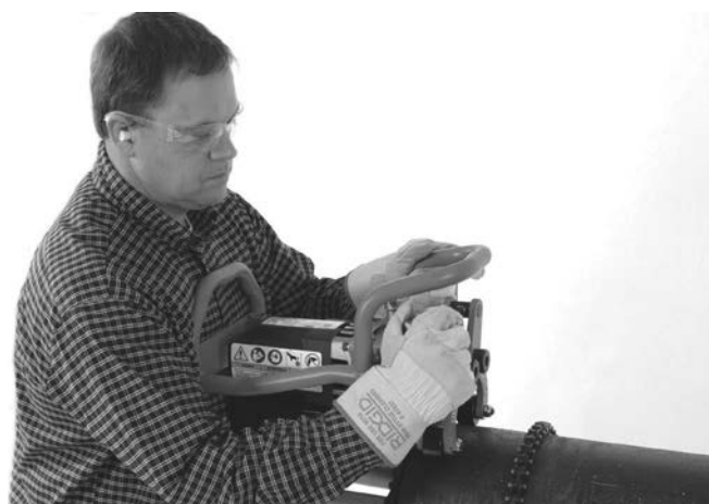
Obrázok 10A – Ručne utiahnite sťahovaciu skrutku
