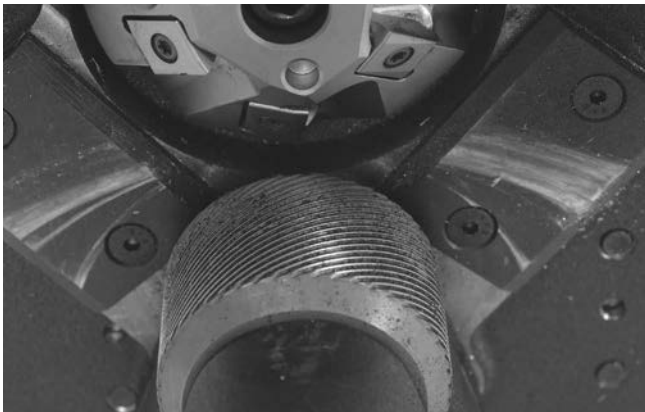
Figura 16 – Pulire le zigrinature del Rullo di trasmissione
