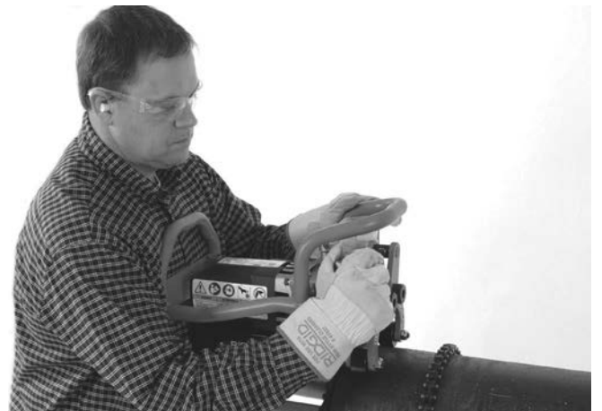
Abbildung 10A – Klemmschraube handfest anziehen
