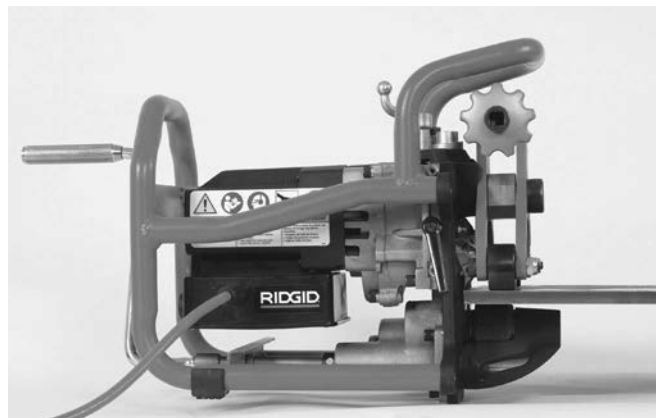
Slika 9B – Montaža alata za obaranje ivica na ploču
