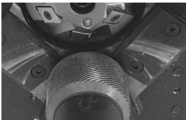
Slika 16 – Čiščenje robnice gonilnega valja
