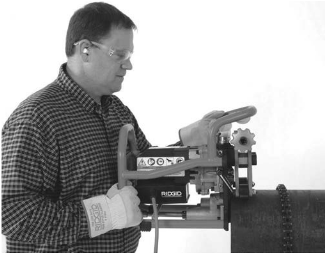
Şekil 8A – Pahlama Makinesinin Boru Üzerine Yerleştirilmesi
