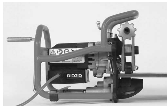
Kuva 9B – Viisteleikkurin asennus levyyn
