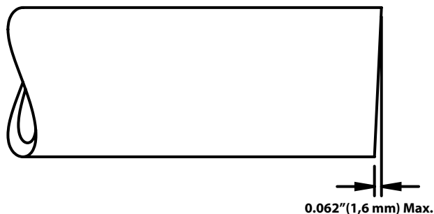
Abbildung 6 – Anforderungen hinsichtlich der Rechtwinkligkeit von Rohren
