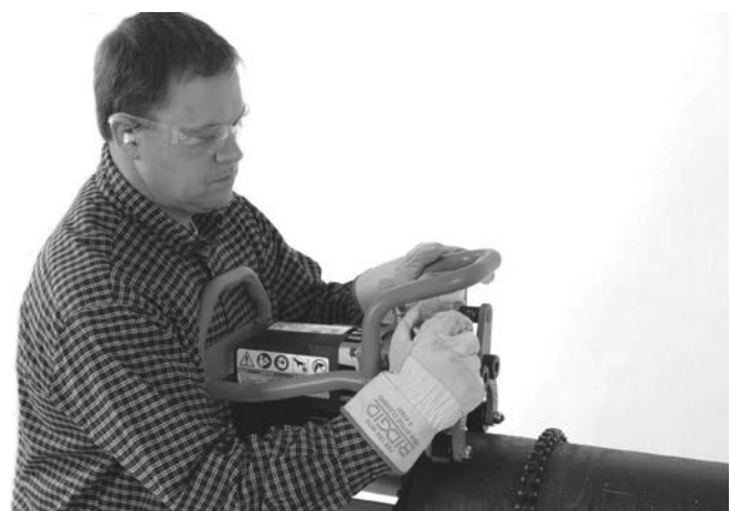
Kuva 10A – Kiristä kiristysruuvi käsin
