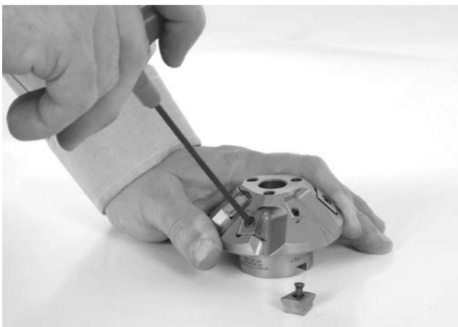
Figuur 18 – Snijkopinzetstukken vervangen
