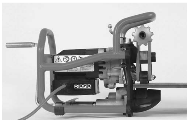
Figura 9B – Montarea mașinii de șanfrenare pe placă
