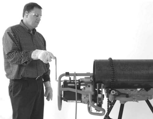
Εικόνα 15B – Εργασία φρεζαρίσματος
