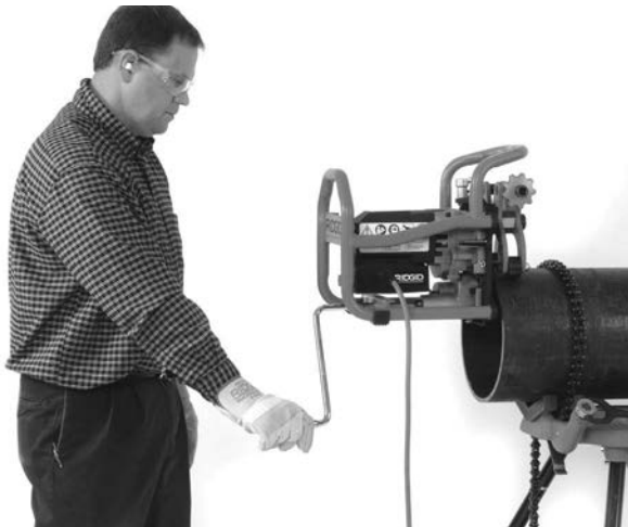
Figura 13 – Posição de Funcionamento Adequada
