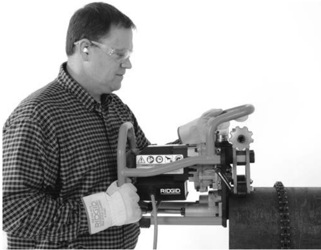
Figure 8A – Positionnement de la machine à biseauter sur le tuyau
