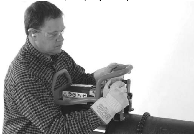
Obrázek 10A – Ručně dotáhněte upínací šroub
