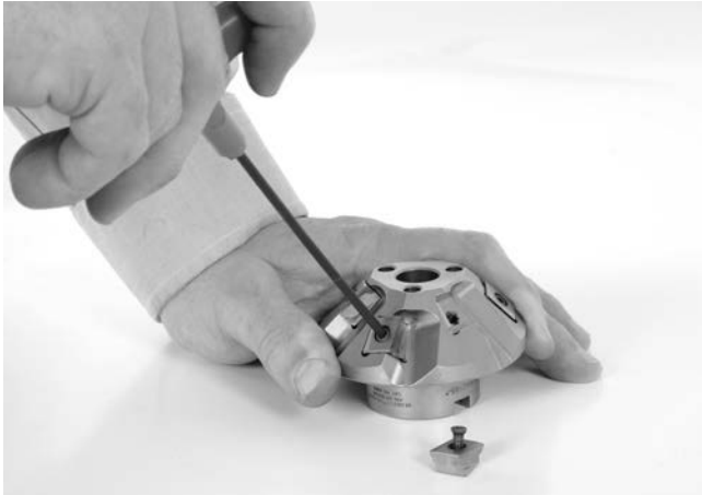
Figure 18 – Remplacement des couteaux
