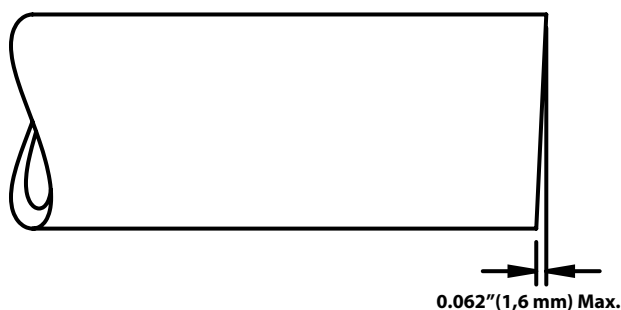
Obrázek 6 – Požadavky rovnosti trubky
