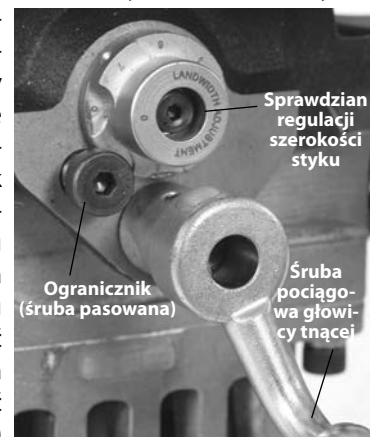
Rys. 12 – Ustawianie sprawdzianu regulacji szerokości styku
