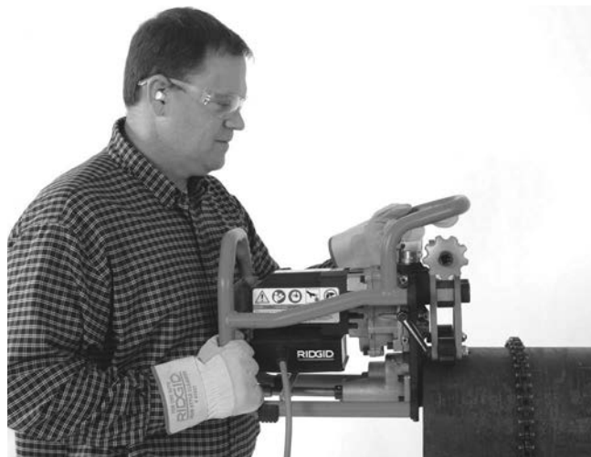
Рис. 8А – Установка станка для снятия фаски на трубу
