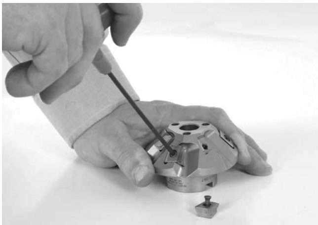
Abbildung 18 – Wechseln der Schneideinsätze
