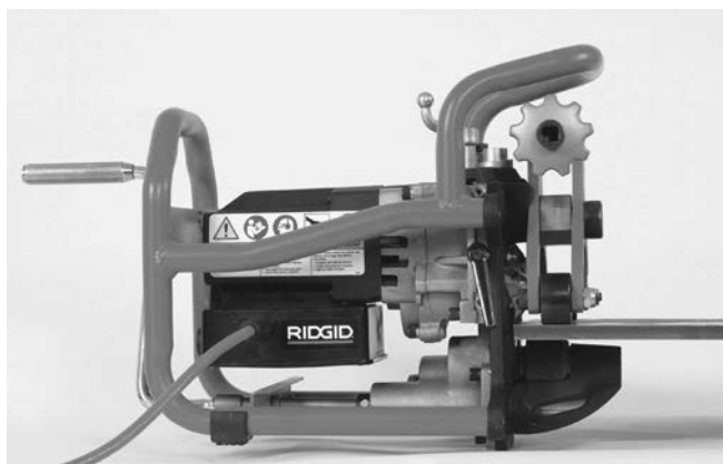
9B ábra – A leélező gép felszerelése a lemezre
