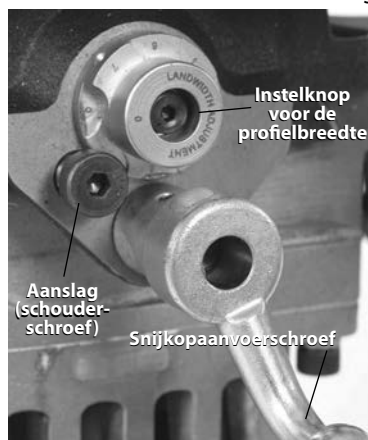
Figuur 12 – Instellen van de instelknop voor de profielbreedte
